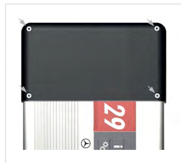
Figura 19: Vano accumulatore di XENTRY Connect
