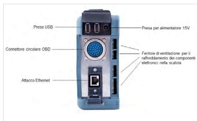
Figura 14: Possibilità di collegamento sul dispositivo XENTRY Connect
