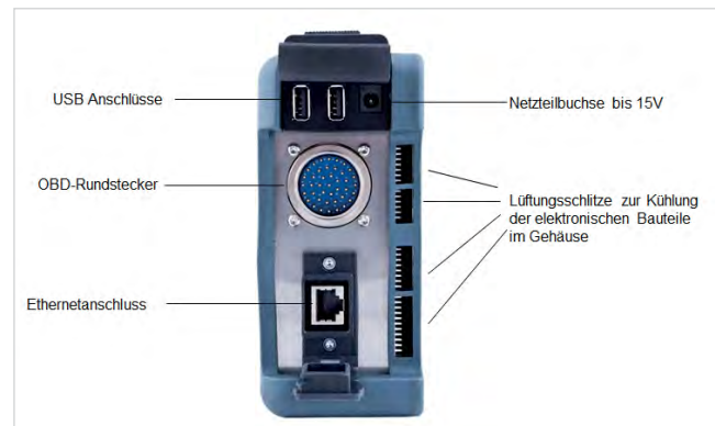
Abbildung 14: Anschlussmöglichkeiten am XENTRY Connect
