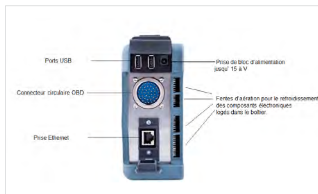
Figure 14 : Possibilités de raccordement sur le XENTRY Connect
