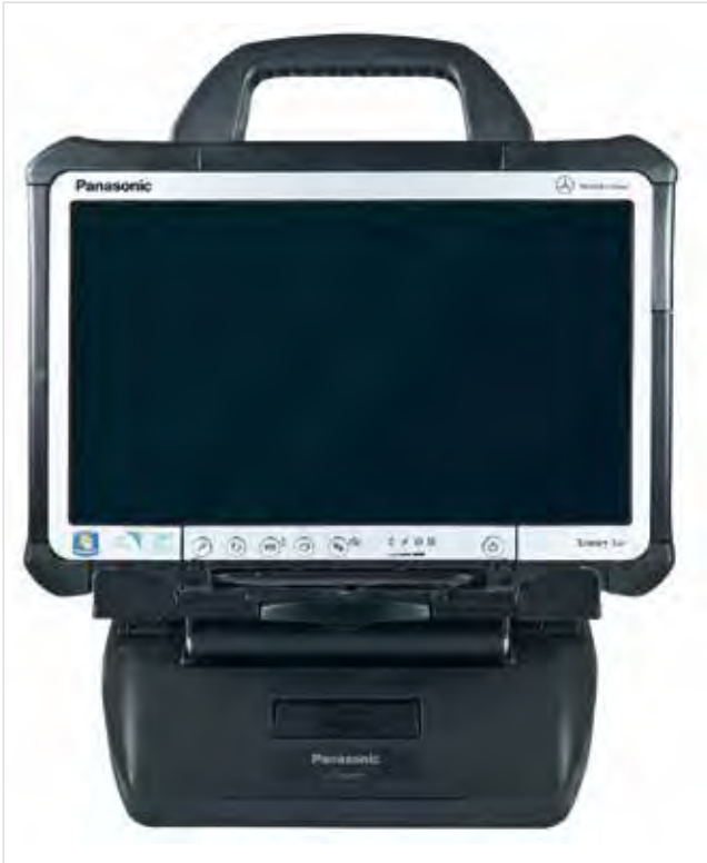
図 22: ドッキング・ステーションに取り付けた XENTRY Tab
